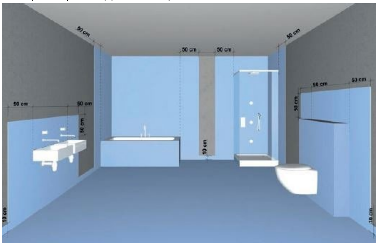
Rys. 1 Strefy wykonania hydroizolacji
